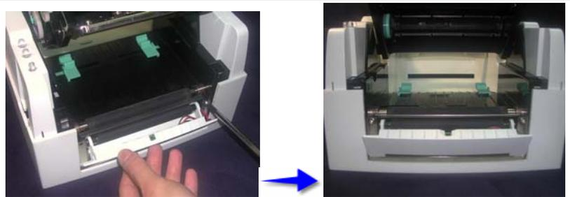
Nehmen Sie das erste Etikett ab und führen Sie das Etikettenmaterial durch die Spendewalze und Spendehalter. Schließen Sie die Spendeeinrichtung.
