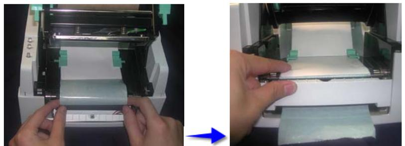
Schließen Sie die Druckmechanik und drücken Sie die FEED Taste.
