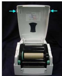
Drücken Sie die Tasten auf der Vorderseite nach innen, um die Abdeckung zu öffnen. Öffnen Sie die Druckmechanik durch Drücken der Verschlusszapfen.
