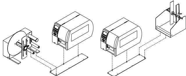
Die Verbindung der PA 50A zum Drucker ist so zu wählen, dass der rechte Gerätedeckel mit der rechten Außenwand der Abwickelvorrichtung bündig ist.
