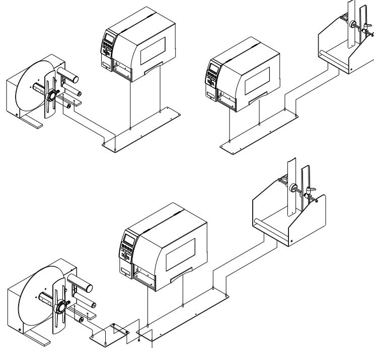
Die Verbindung der PA 50A zum Drucker ist so zu wählen, dass der rechte Gerätedeckel mit der rechten Außenwand der Abwickelvorrichtung bündig ist.
